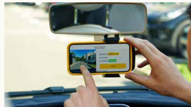
Un simple smartphone fixé sur le pare-brise suffit pour ausculter la voirie.
